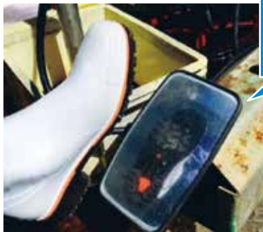
靴底の汚れをチェックしやすくするために鏡を設置している事例
