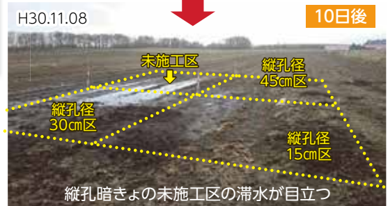
写真3 試験区の滞水状況の推移
