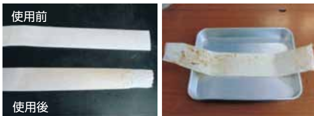
写真1 フィルターソックスの汚れ
