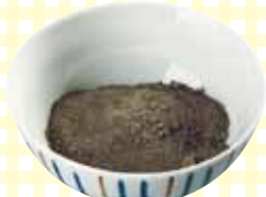
ペレットを燃焼させるとの灰が残る。量は比較的少なくペレット10kgで130cc (写真) ほど
