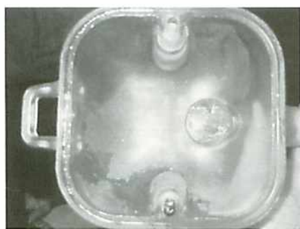
1. クロー内部の汚れ
