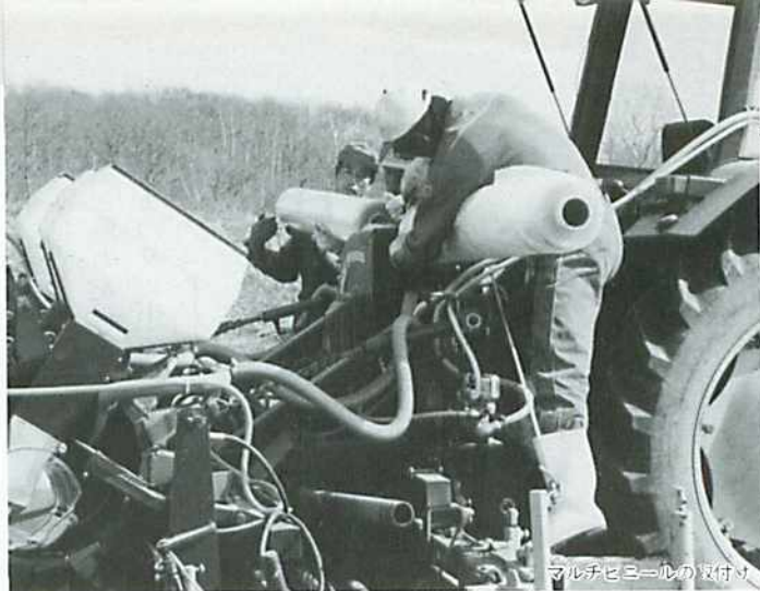
マルチビニールの取り付け
