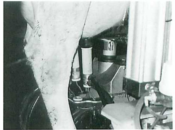
搾乳中も牛の動きをセンサーがキャッチしアームが前後に動く
