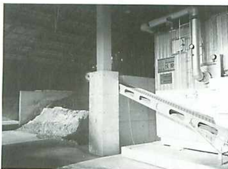
堆肥発酵機「沃野」と隣が機械から出された堆肥で、下からエアレーションされている
