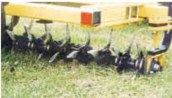
写真1 エアウェイ(刃が土中に入り込んだ状態)
